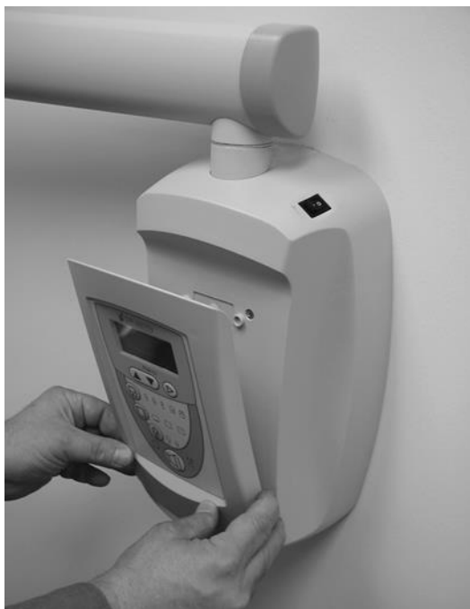
صورة ٣٧ التثبيت في لوحة التشغيل
