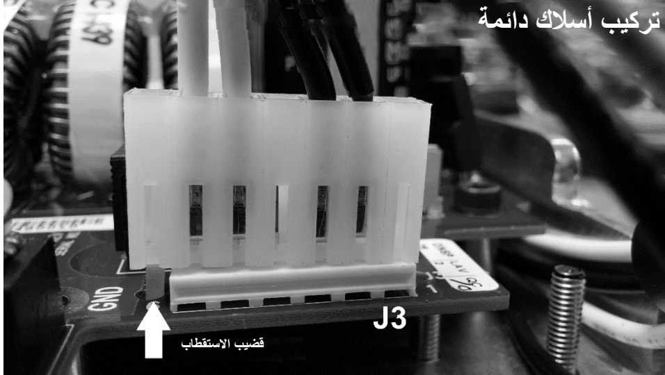
صورة 27 تكوين ضفيرة أسلاك مفاتيح الطاقة من أجل تركيب أسلاك دائمة
